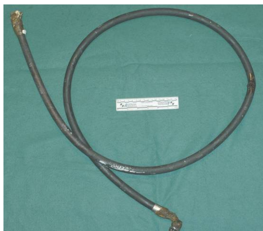
Bilde 2: Hydraulikkslangen mellom Coupler-ventilen og strømningskontrollventilen (Kilde: StatoilHydro)
