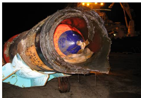
Figur 5: Illustrasjon av lokasjon av brudd på lasteslangen (Kilde: StatoilHydro)
